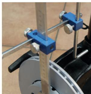
Régler les tiges graduées en touchant l'œillet de fixation amortisseur.
