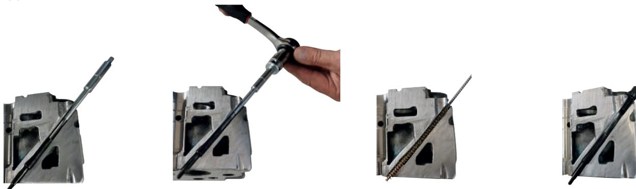
permet la production d'un nouveau filet en profondeur à l'intérieur de la bougie.
