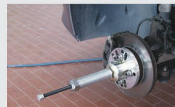
Extraction de l'arbre de transmission en utilisant un vérin mécano-hydraulique 16 tonnes, Code **GO1016** (optionnelle)
