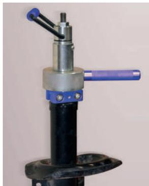
Visser le tire-tige dans le support et positionner l'unité sur la tige de l'amortisseur. Fixer la tige au tire-tige avec écrou de blocage.
