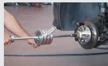
Extraction du moyeu de la roue au moyen de la masse à inertie, Code **GO520**
