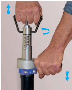
Extraire le tire-tige et le bloquer avec une légère rotation vers droite ou gauche. N.B : il est possible d'extraire la tige de 20mm supplémentaires en maintenant fixe le support et tournant le tire-tige
