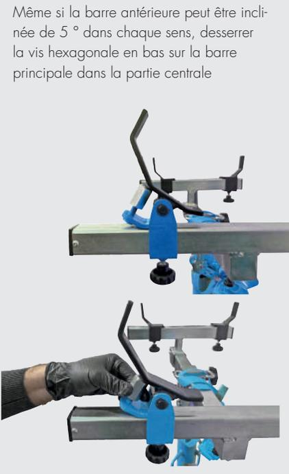
Même si la barre antérieure peut être inclinée de 5° dans chaque sens, desserrer la vis hexagonale en bas sur la barre principale dans la partie centrale
