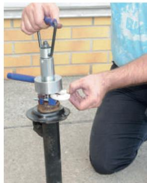
Si la course du tire-tige résulte insuffisant : insérer un ou deux entretoises, en dotation, entre le support et le mors, afin d'extraire ultérieurement la tige de l'amortisseur.
